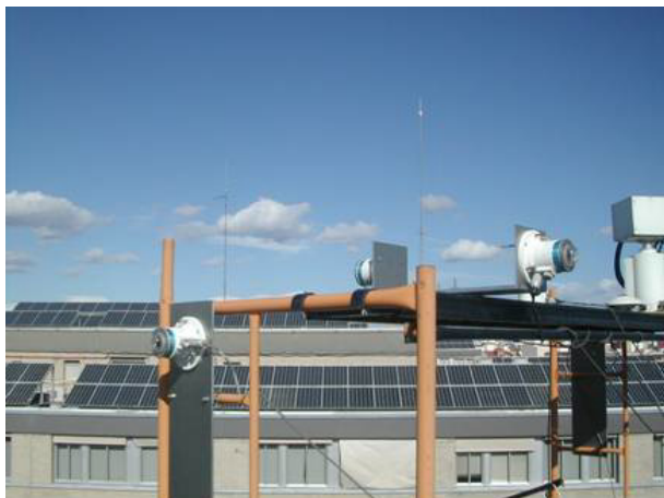
Figura 1. Dispositivo experimental para medida de la radiación ultravioleta eritemática (UVER) en planos verticales (vista parcial).
